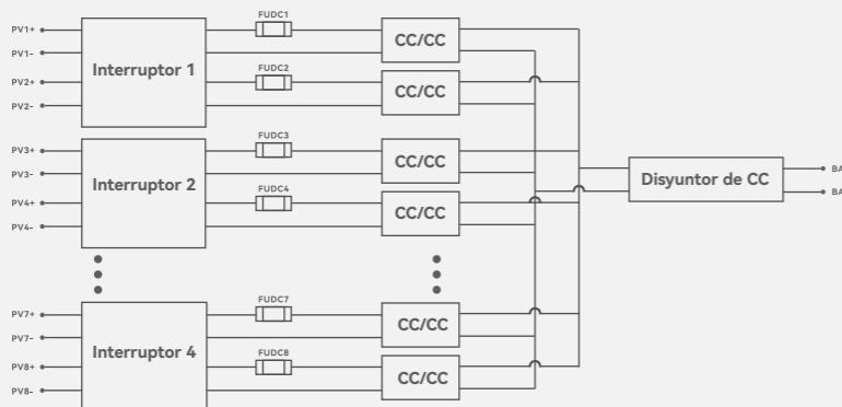
Nota: La configuración final depende de los parámetros reales de los módulos fotovoltaicos o del plan del proyecto.
